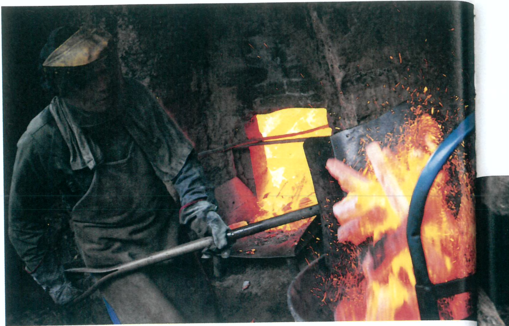
위. 새벽 6시부터 이어지는 백탄 꺼내기 작업은 고열에 노출되는 위 험한 일이므로 안전장비는 필수다. 백탄을 꺼낸 이후에는 흙이나 재 로 덮어 불을 끄고 유황이나 수분을 완전히 연소시켜야 한다. 아래. 태백산참숯가마에서는 가마에 불이 꺼지는 날이 없다. 가마 앞에 쌓인 참나무는 6~7일이면 백탄으로 다시 태어나고, 숯을 만 드는 동안 발생하는 연기는 목초액으로 탈바꿈한다.
